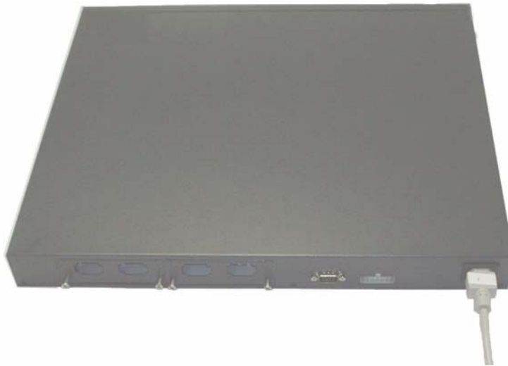
Obr. 1-2. Připojení napájecího kabelu
