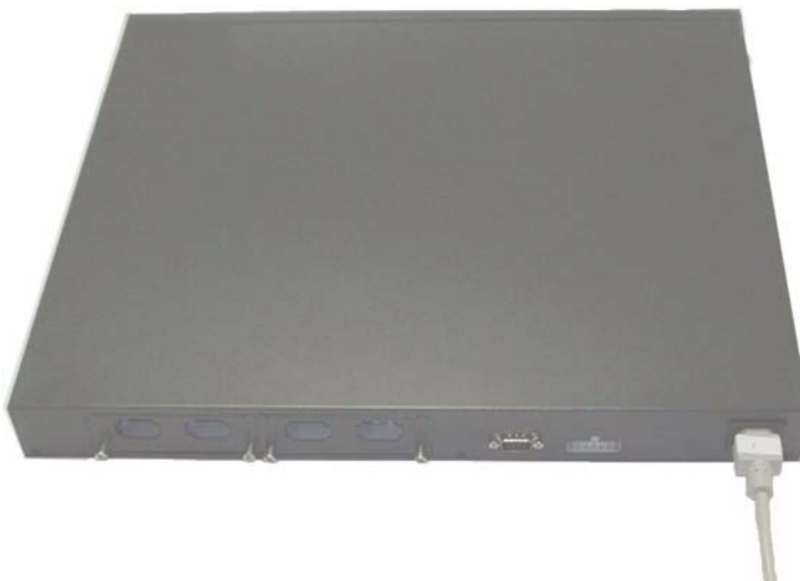
図 1-2 電源ケーブルの接続
