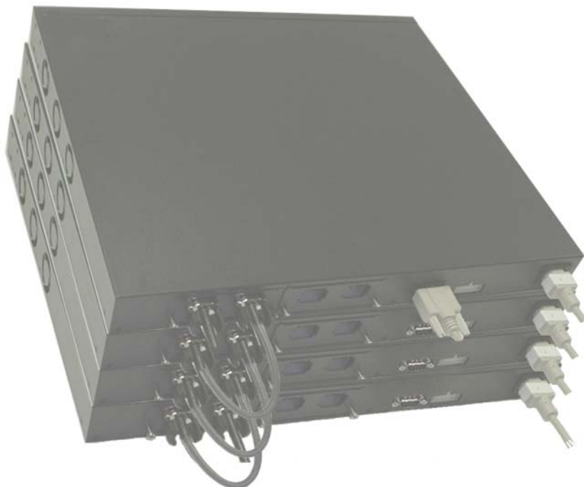
Obr. 1-3. Propojení stohu přepínačů
